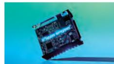
Die iPiezo-Steuerung stellt in Abhängigkeit der Bedingungen am Zahn sicher, dass stets die richtige Leistung an der Spitze des Aufsatzes anliegt. So ist auch bei hartnäckigem Zahnstein eine sicheres, effizientes Scaling gewährleistet.
